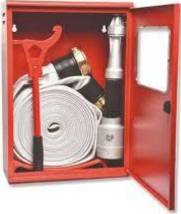
Comunemente conosciuti col nome di cassette antincendio, gli **idranti a muro** si compongono di una **cassetta murata o sporgente**, di un **rubinetto idrante** e di una **lancia e tubazione flessibile, raccordabile**, denominata **manichetta**, della lunghezza massima di 20 metri. La tubazione ha un diametro di 45 mm, caratteristica che conferisce a questo tipo di cassetta l'appellativo di cassetta idrante UNI 45.
